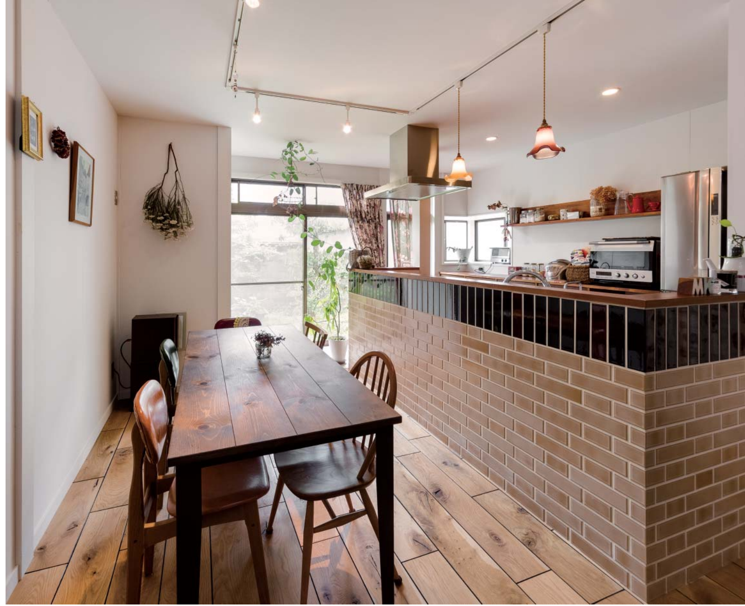
K氏は必要な耐震補強を施し、1階はワンフロア＝LDKに。壁は真壁にペニヤを貼って白塗装、トイレ以外の水廻りも入れ替えた
