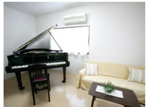
①元和室はピアノルームに。床は大引と根太のピッチを狭くし頑丈に補強。遮音シートと二重サッシ・複層ガラスで遮音に配慮
